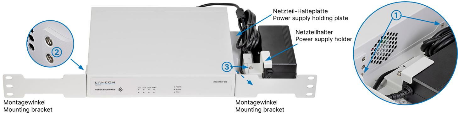
Beginnen Sie mit der Montage der Netzteil-Halteplatte, indem Sie auf der rechten Geräteseite die unteren beiden Gehäuseschrauben ① aus dem Gerät entfernen.
