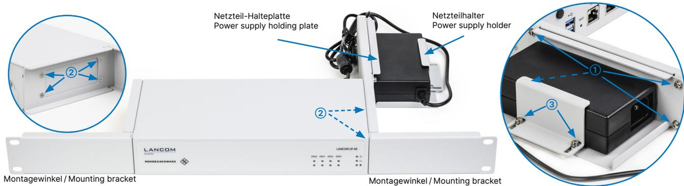
Beginnen Sie mit der Montage der Netzteil-Halteplatte, indem Sie diese mit 4 der 6 mitgelieferten Schrauben mit Unterlegscheiben ① mit dem rechten Montagewinkel verschrauben.
